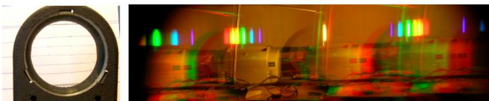
Рис. 4. Фотографии мнимых изображений, получаемых с помощью фотоаппарата и оптического устройства (указано в скобках), помещенного перед объективом: слева – линии на листке бумаги (рассеивающая линза); справа – линейчатый спектр «экономной лампы» (дифракционная решетка)
